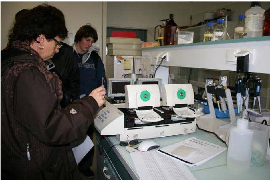
Découverte des appareils du laboratoire de génétique, ici un thermocycleur permettant la réalisation de PCR (pour copier un grand nombre de fois des gènes)
